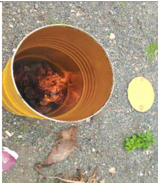
proceso de la incineración de la cascarilla de cacao y raquis de plátano para la elaboración del Biochar
